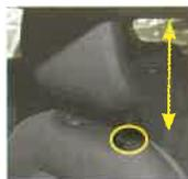
**i** Le réglage de la hauteur de l'appui-tête se fait à l'aide d'un bouton situé à la base des fourreaux.
