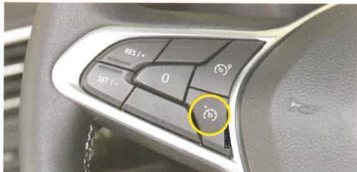
57 Si le véhicule en est équipé, montrez la commande du **limiteur de vitesse**.
